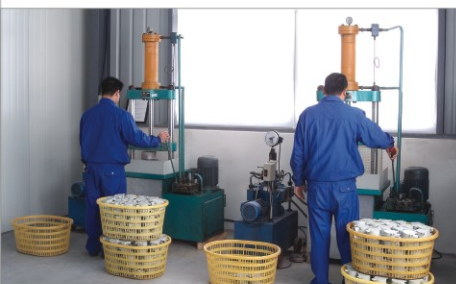
水压试验 Hydraulic pressure testing
