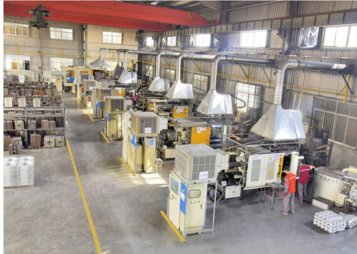
自动浇注铸造车间 Automatic pouring casting workshop
