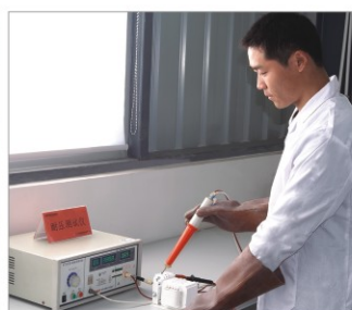
高压测试 High-voltage test
