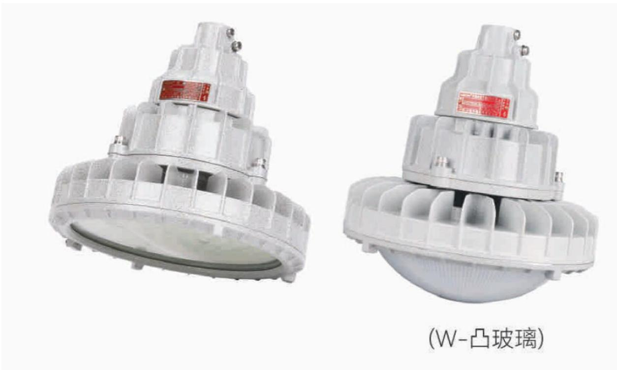
**HLBT56 防爆高效节能 LED 泛光灯:** 1. 铸铝合金压铸外壳, 表面高压静电喷塑, 外形美观; 2. 抗高能量冲击的钢化玻璃透明件, 不锈钢外露紧固件; 3. 密封圈采用耐高温、抗老化硅橡胶, 具有良好的防尘、防水性能; 4. 光源腔、电器腔、接线腔相互独立, 减少了光源热量对电器腔恒流源的影响, 从而确保了灯具的使用寿命, 接线时只需打开接线腔, 安装维护方便、安全; 5. 多颗国际品牌 LED 合理排布高效节能, 发光效率 140lm/W. 显色性 280, 超长寿命>5 万小时, 长期使用免维护; 6. 二次光学设计, 专用防眩反光罩, 有效提高灯具的使用效率, 照度均匀; 7. 国内知名品牌电源宽电压(90~305V)输入, 恒功率输出, 功率因数 20.98, 具有恒流、过流、开路、短路、防浪涌等保护功能; 8. 色温:5700K, 色温可订制; 9. 特制了角度调节机构, 可根据用户现场要求, 调整照射角度, 灯体可水平或壁式安装; 10. 电缆布线。
